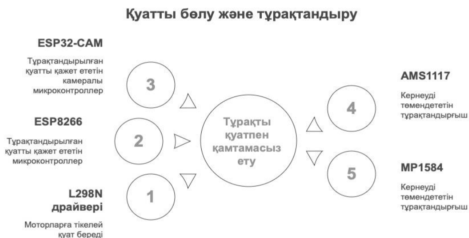
3.7-сурет – Қуатты бөлу және тұрақтандыру схемасы
