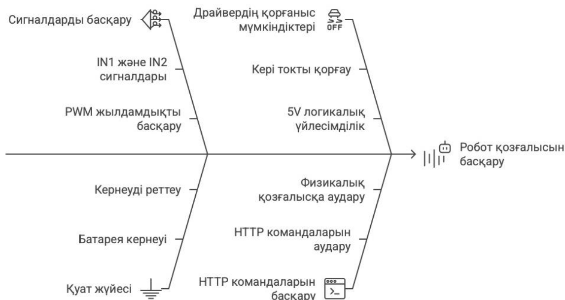
3.5-сурет – ESP8266 және L298N арқылы робот қозғалысын басқару
